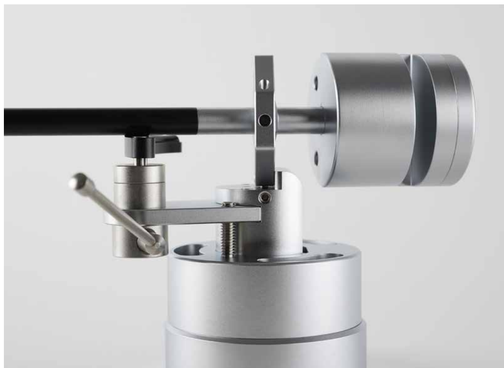
Nur das von vorne gesehene rechte Tonarmrohr läuft auf der Hauptdrehachse des Simplicity. Das zweite ist leicht versetzt daneben und ermöglicht so eine Änderung der Kröpfungswinkel an der Headshell.
