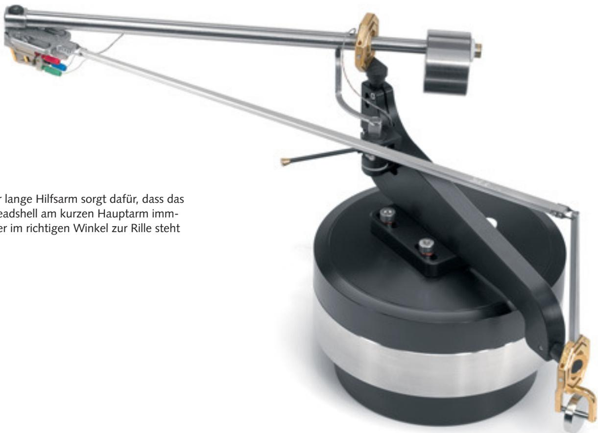
Der lange Hilfsarm sorgt dafür, dass das Headshell am kurzen Hauptarm immer im richtigen Winkel zur Rille steht
